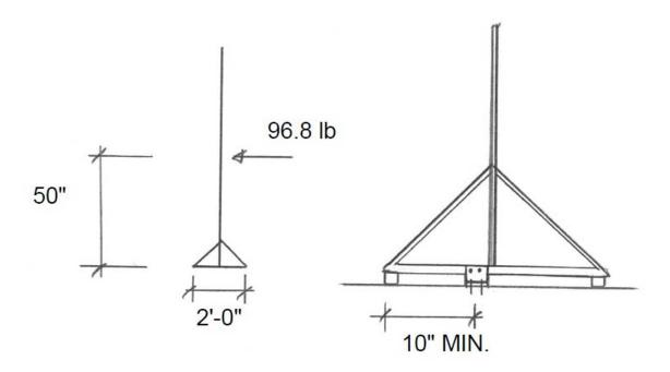
MAX. FACTORED UPLIFT FORCE @ SEISMIC ANCHOR:
