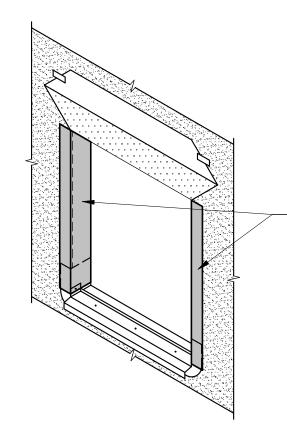
WRAP SELF-ADHERED FLASHING INTO ROUGH OPENING AT JAMBS FULL HEIGHT OF JAMB. ROLL DOWN TIGHT TO ACHIEVE PROPER ADHESION USING A 2-HANDED ROLLER AND HEAVY PRESSURE
