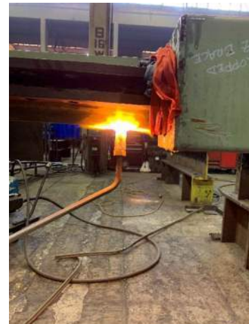
(d) Heat Flare on Bent Lug
